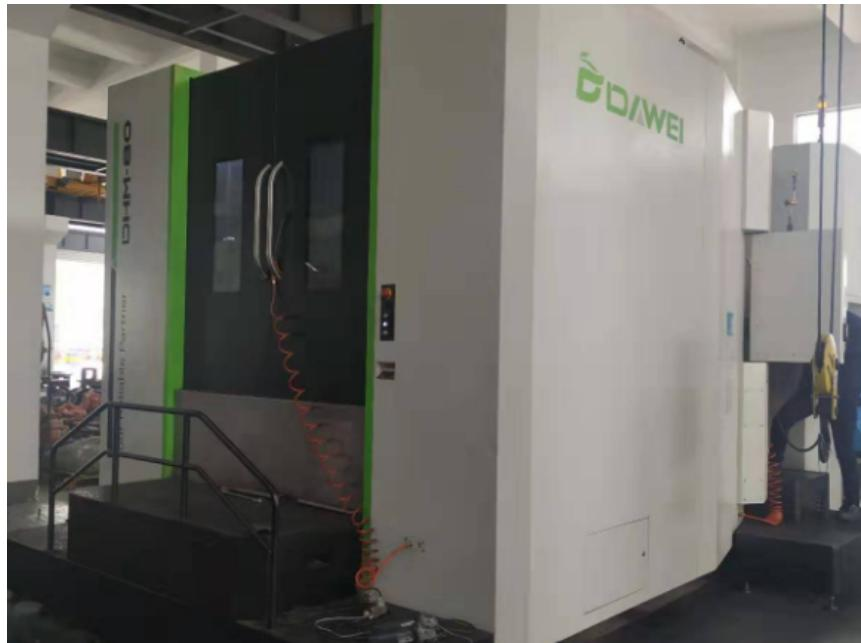
线轨数控机床的日常管理和维护：1、严格遵守操作规程；机床的编程、操作和修理人员需要进行专门培训，能按说明书合理、正确运用，尽量防止由于操作不当引起的毛病。一起要按要求进行日常保护，做好部件的清洗、加油和更换作业。2、做好磁盘阅读机的定时保护；磁盘阅读机是数控机床数控输入的重要设备，数控系统的参数、程序都要经过其输入，加强其定时保护十分必要。3、常常监测数控系统的电网电压；电网电压对数控机床的安稳运转至关重要，要常常注意电网电压的波动。在电网质量恶劣的地区，应配备稳压设备。4、定时查看和更换直流电刷；这种电刷归于磨损性配件，要做到定时查看。关于一般数控机床，应该每年查看一次，而频频加快机床则需要每月查看一次。
