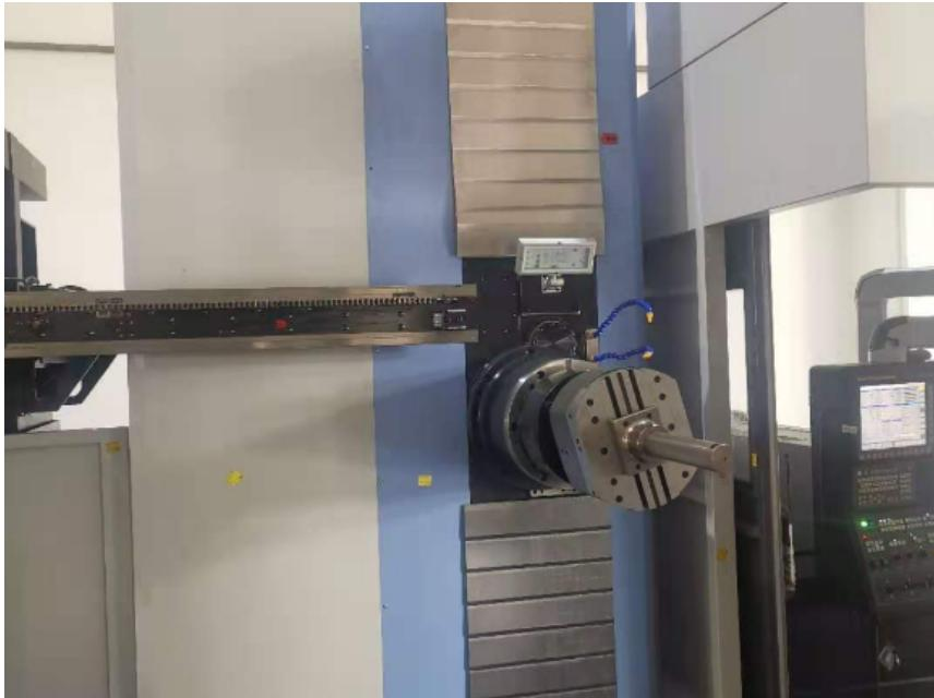
说起数控车床，可能广大人民群众对此还是比较陌生，因为它不是我们日常生活中普遍见到的设备，但是在机械行业，数控车床是较为常见的机械设备，生产各类零件都少不了它，正是有了它，加工工序简化了，加工时长缩短了，工厂效益提高了。数控车床工件加工较常遇到的问题和解决方案：工件产生锥度大小头现象。故障原因：数控机床放置的水平没调整好，一高一低，产生放置不稳定；车削长轴时，贡献材料比较硬，刀具吃刀比较深，造成让刀现象；尾座顶针与主轴不同心。解决方案：使用水平仪调整数控机床的水平度，打下扎实的地基，把数控机床固定好提高其韧性；选择合理的工艺和适当的切削进给量避免刀具受力让刀；调整尾座。平行控制数控铣床销售商数控机床水冷电主轴需通从循环冷静却液进行冷静却。
